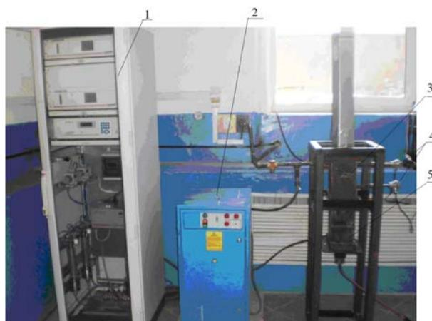
**Рис. 1 - Экспериментальный стенд для исследования процессов протекающих в восстановительной зоне реактора: 1 - газоанализатор; 2 - парогенератор; 3 - реактор; 4 - термопары; 5 - нагреватель газов**
