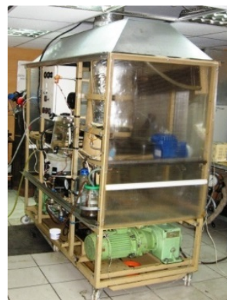
Рис. 2 - Пилотная проточная установка для исследований процесса СКВО
