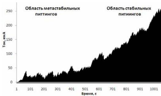
Рис. 2 - Изменение суммарного значения тока (мкА): частота зарождения  $\lambda=0,05 \text{ см}^{-2} \text{ с}^{-1}$ , доля пассивирующихся питтингов  $Q=0,08$ , количество секторов  $N=50$ , время эксперимента  $T=1000 \text{ с}$ , критическое время  $\tau_{cr}=100 \text{ с}$ , индукционное время  $\tau_{ind} \in [0,70] \text{ с}$ , скорость нарастания тока  $C = 0,1 \text{ мкА/с}$
