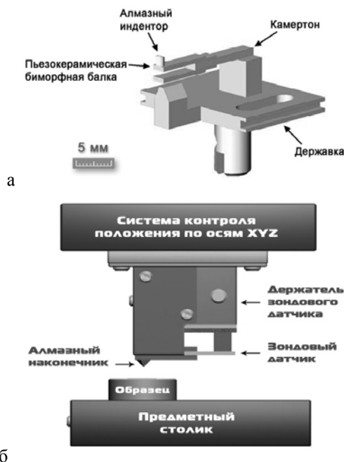
Рис. 2 - Конструкция системы нагружения: а) зондовый датчик-кантилевер с установленным алмазным индентором; б) система нагружения сканирующего наноиндентометра «НаноСкан-3D»
