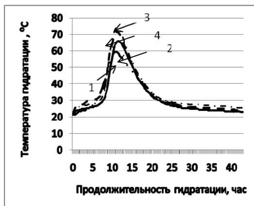
Рис. 1 - Кинетика тепловыделения при гидратации ЦК на Вольском портландцементе: 1 - без добавки; 2 - с добавкой 1% СП-1; 3 - с добавкой (1% СП-1 + 0,0005% «Graphistrength»); 4 - с добавкой (1% СП-1 + 0,0005% «Таунит»)
