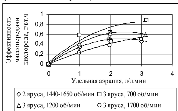
Рис. 4 – Зависимость эффективности массопередачи кислорода от удельной аэрации для многоярусных мешалок
