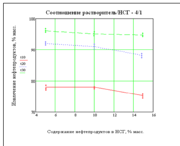
Рис. 4 - Графики зависимости степени извлечения нефтепродуктов (%) в зависимости от температуры проведения экстракции и содержания нефти в НСГ при соотношении «растворитель : НСГ» = 4:1: — при 10°C; ... при 20°C; - - - при 30°C
