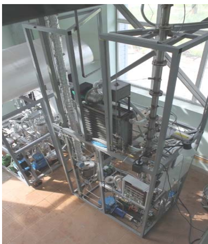
Рис. 1 – Экспериментальная установка для исследования процесса ректификации
