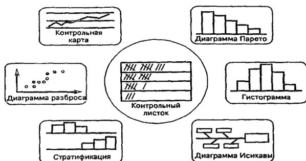
Рис. 1 – Семь инструментов контроля качества
