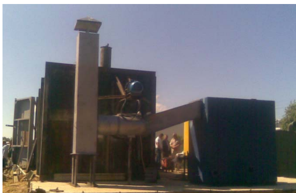
Рис. 1 - Промышленная установка по термическому модифицированию древесины в среде топочных газов
