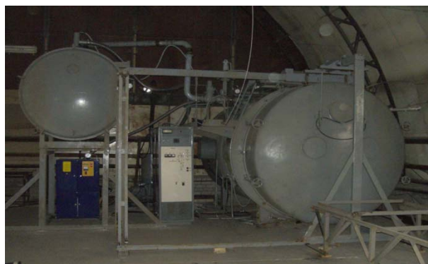
Рис. 2 - Установка термомодифицирования пиломатериалов в среде перегретого пара
