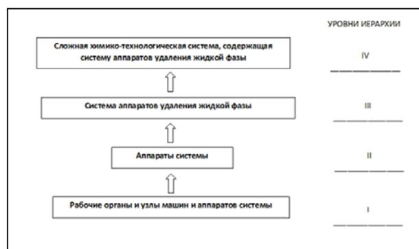
**Рис. 1 - Функциональная схема отделения жидкой фазы**
