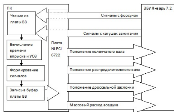
Рис. 1 - Функциональная схема эмулятора ДВС
