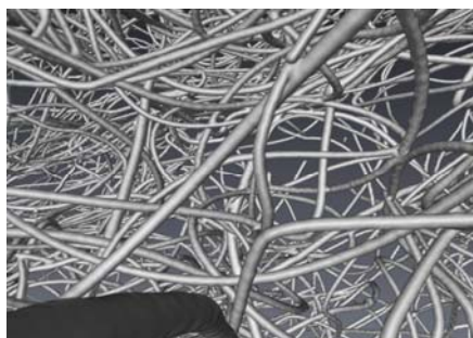
Рис. 2 – Расположение мононитей в структуре нетканого полотна «Холлофайбер Волюметрик Р 179»
