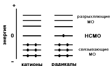
Рис. 1 – Схема энергетических уровней МО в катионах и радикалах нечётных альтернантных углеводов
