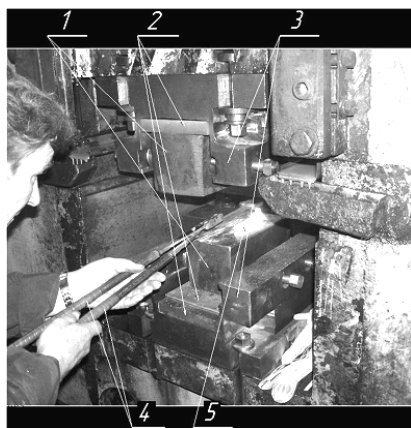
Рис. 2 – Пресс чеканочный для объемной штамповки: 1 – штампы; 2 – подкладные плиты; 3 – блок крепления штампов; 4 – клещи для подачи заготовки в зону штамповку
