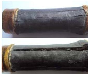
**Рис. 6 – Вид гибкого анода после испытаний в минерализованной среде**
