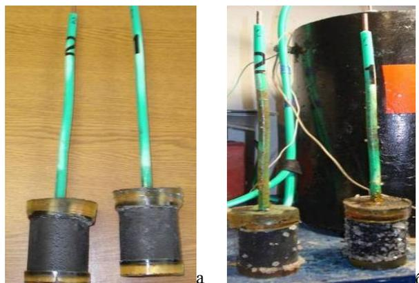
**Рис. 7 – Внешний вид образцов ПГА: а – до испытания; б – после испытания**
