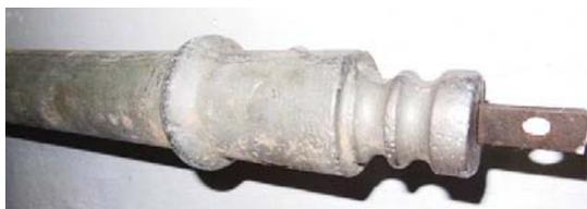
**Рис. 2 - Ферросилидовый электрод анодного заземлителя ГАЗ-М**
