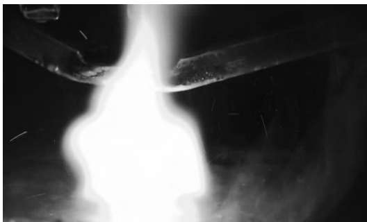
Рис. 3 – Фотография перехода слабotoчного в сильноточный ВЧЕР с струйным электролитическим анодом при атмосферном давлении, I_c = 20 мм, v = 0,9 м/с, U = 3000 В. Электролит – 3%-й йодированный раствор NaCl в технической воде
