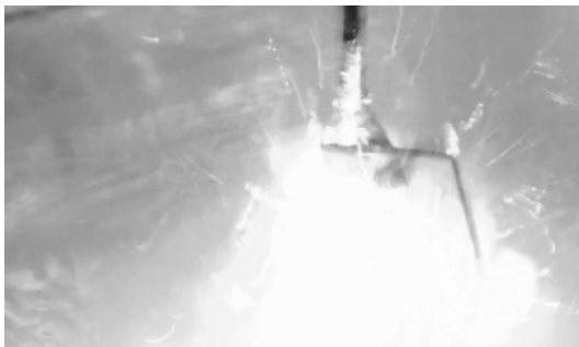
Рис. 4 – Фотография перехода слабotoчного в сильноточный ВЧЕР с стальным электродом, погруженным в непроточный электролит при P = 10^5 Па, U = 6000 В
