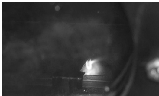
Рис. 2 – Фотография перехода слаботочного в сильноточный ВЧЕР с струйным электролитическим электродом при P = 2100 Па, U = 1000 В, I_c = 20 мм, v = 0,9 м/с. Электролит – 3%-й йодированный раствор NaCl в технической воде
