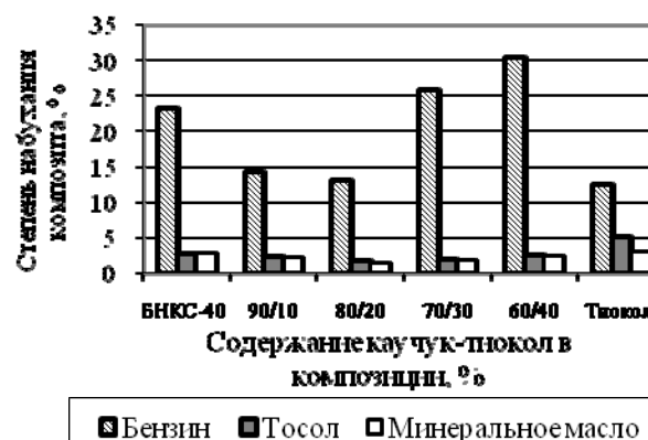
Рис. 1 - Степень набухания композиций на основе бутадиен-нитрильного каучука и тиокола при температуре 23°С в течении 72 часов
