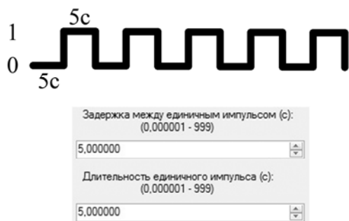
Рис. 3 – Пример работы автоматически сгенерированного кода для случая “Формирователя единичных импульсов”
