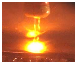
Рис. 2 - Фотография ЭР между струйным электролитическим анодом и медным катодом при t = 0,08 с, P = 10^5 Па, G = 4 г/с, v = 0,5 м/с, U = 475 В, l_c = 10 мм и d_c = 3 мм. Электролит – насыщенный раствор NaCl в технической воде
