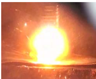
Рис. 4 - Фотография ЭР между струйным электролитическим анодом и медным катодом при t = 0,16 с, P = 10^5 Па, G = 4 г/с, v = 0,5 м/с, U = 455 В, l_c = 10 мм и d_c = 3 мм. Электролит – насыщенный раствор NaCl в технической воде
