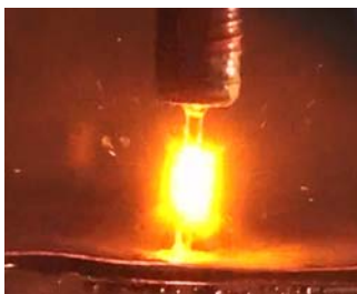
Рис. 3 - Фотография ЭР между струйным электролитическим анодом и медным катодом при t = 0,12 с, P = 10^5 Па, G = 4 г/с, v = 0,5 м/с, U = 465 В, l_c = 10 мм и d_c = 3 мм. Электролит – насыщенный раствор NaCl в технической воде
