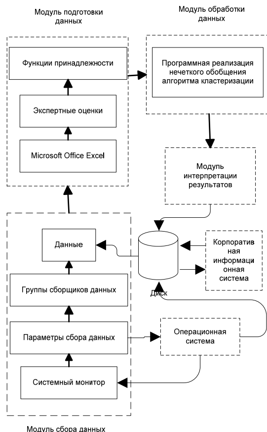
Рис. 1 - Архитектура системы, предназначенной для автоматизации построения пользовательских ролей
