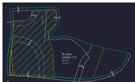
Рис. 2 – Конструкция обуви с нормальной фиксации голеностопного сустава
