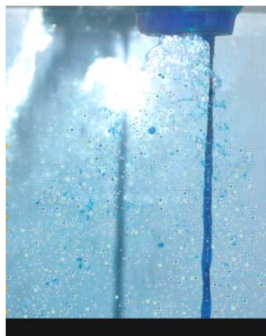
Рис. 2 – Фотография факела распыла воды температурой 21°C из центробежной форсунки с вкладышем
