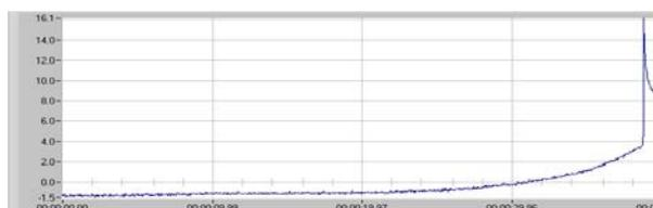
**Рис. 1 – Зависимость давления в стенде от времени горения комбинированного заряда (АХ/ГХЭ = 82,5/17,5)**
