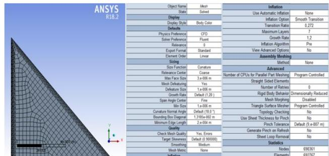
Рис. 2 - Сетка для части канала
