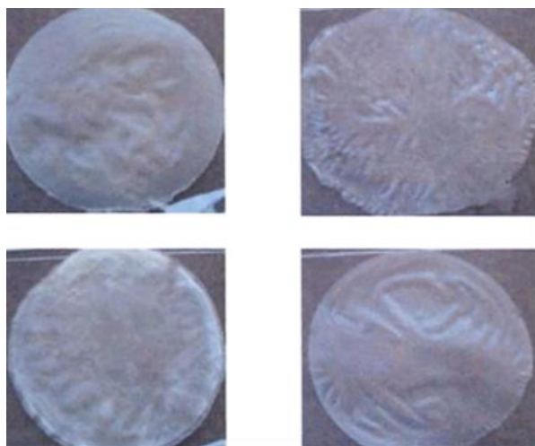
Рис. 1– Внешний вид образцов биоразлагаемых покрытий на основе поливинилового спирта и каррагинана
