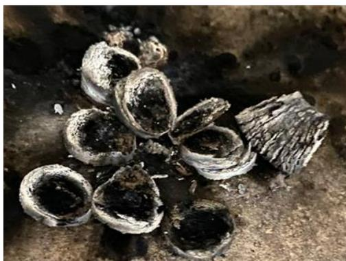
Рис. 5 – Фотографии продуктов сгорания системы кремний-фторхлорполимер при содержании горючего более 50 % масс. (общий вид)
