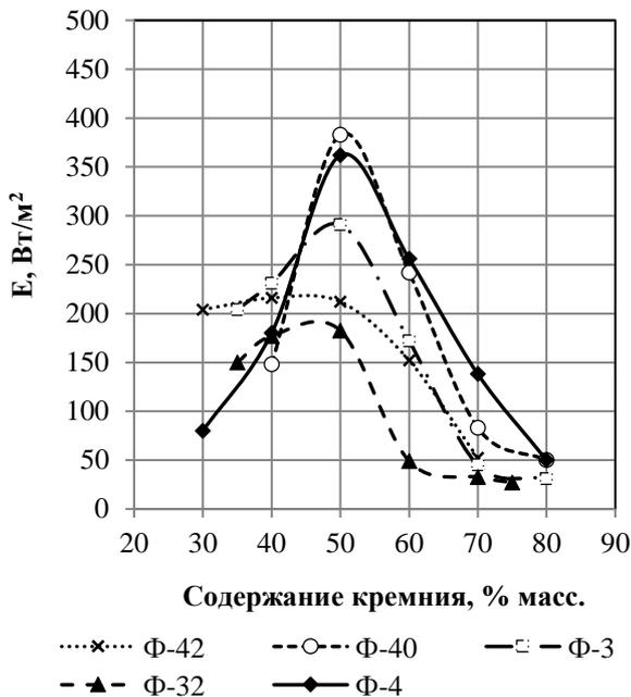
Рис. 2 – Зависимость энергетической освещенности (E) смеси кремний-фторорганика от содержания кремния
