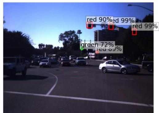
Рис. 4 – Пример распознавания сигналов светофора моделью YOLOv8n
