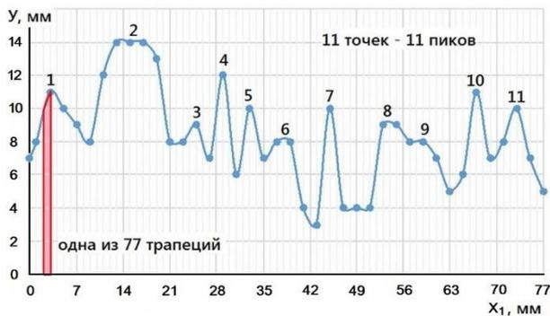
Рис. 1 – Пояснения к расчету параметра шероховатости по формуле (1)
