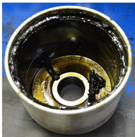
**Рис. 4 – Общий вид внутренней поверхности стакана ротора центробежного маслоочистителя двигателя Д-245.12С**
