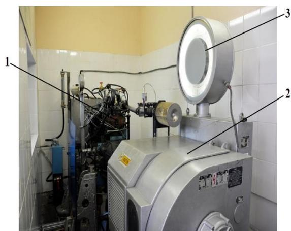
1 – дизельный двигатель Д-245.12С; 2 – динамометрическая машина; 3 – весовая головка
