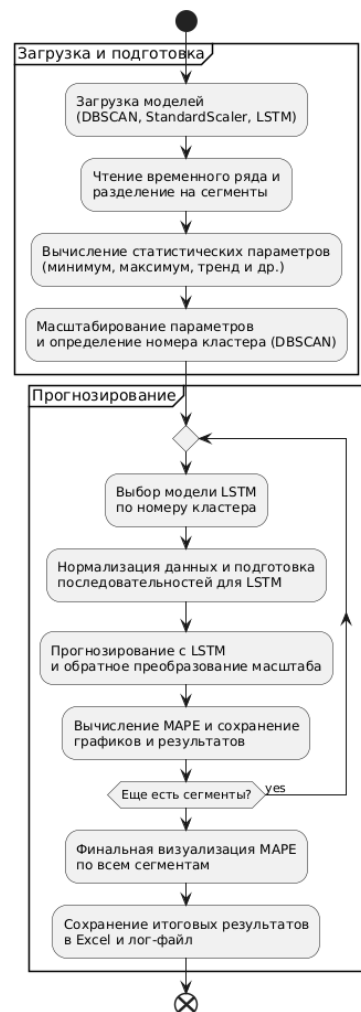
Рис. 4 – Алгоритм работы блока прогнозирования Fig. 4 – Algorithm of the forecasting block operation
