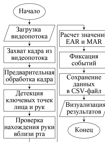
Рис. 1 – Блок-схема алгоритма обработки кадров из видеопотока
