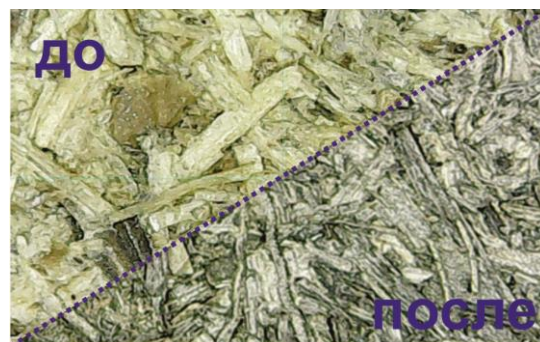
Рис. 3 – Результаты микроскопирования лицевой поверхности образца ПБС до и после экспозиции в почво-грунте (90 сут)
