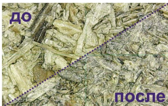
Рис. 2 – Микрофотография (400х) образца ПБС до и после испытаний на водопоглощение по объему Fig. 2 – Micrograph (400x) of a PWR sample before and after volume water absorption tests
