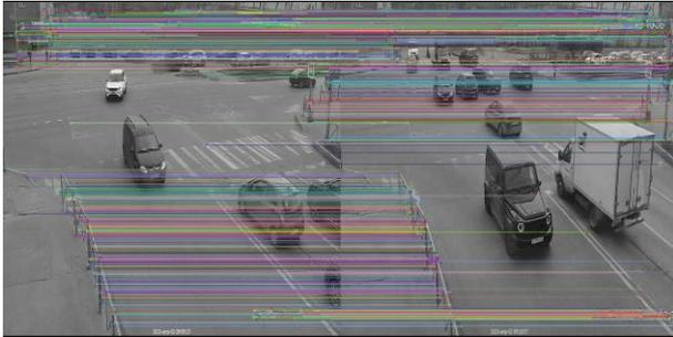
**Рис. 1 – Пример сопоставления опорных точек при статичном положении камеры**
