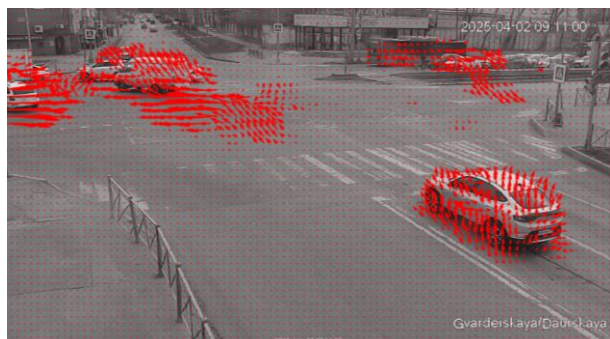
Рис. 1 – Пример сопоставления кадров методом оптического потока при статическом положении камеры
