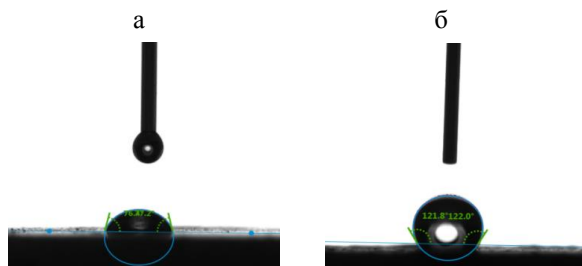
Рис. 2 – Изображение капли дистиллированной воды на не модифицированной поверхности диоксида кремния (а), на модифицированной поверхности диоксида кремния частицами ПММА (б)
