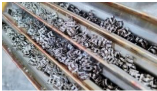
Рис. 3 – Теплообменник с хаотичными элементами в каналах
