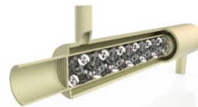
Рис. 2 – Вид теплообменника в разрезе с хаотичной насадкой
