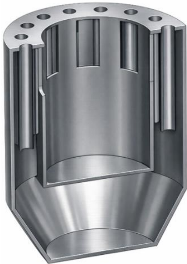
Рис. 1 – Трехмерная модель классификатора в разрезе
