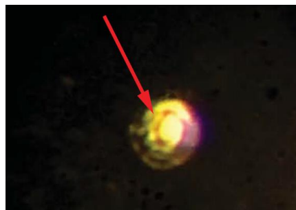
Рис. 2 - Фотография образца твердого водорода при давлении ~ 500 ГПа [16]. Размеры образца составляют ~8-10 \mu\text{m} , толщина ~1.2 \mu\text{m} . Стрелка указывает на объект, окруженный металлическим рением
