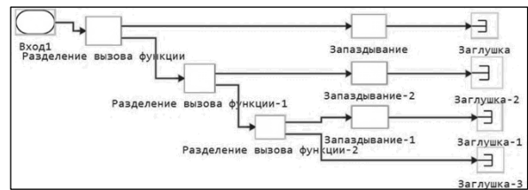
Рис. 3 - Имитационная модель двухканальной СМО с отказами в Engee
